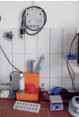
(Abb. 5) IQ-Modul mit Sensoranschlusskabel für Kalibrierungen von Sensoren im Labor
